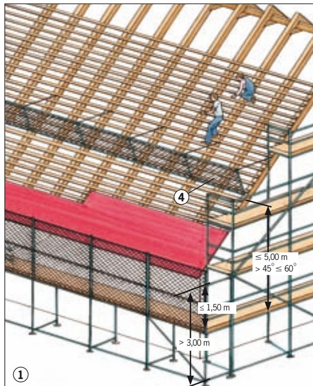
Wenn aus arbeitstechnischen Gründen bei Dacharbeiten kein Seitenschutz verwendet werden kann, müssen stattdessen Dachfanggerüste angebracht werden, die ein Auffangen abstürzender Personen gewährleisten. Dieses gilt für:
